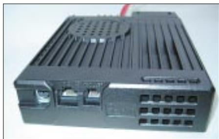
**Auch auf der Vorderseite eine Black Box: Hier sind nur Anschlüsse für Bedienteil, ein Modem und falls gewünscht das Mikrofon**
