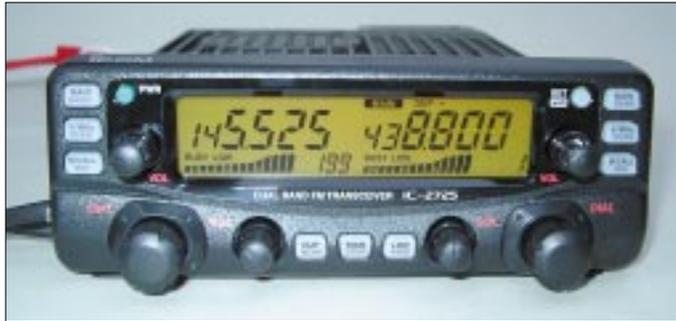
Damit nicht genug: Obwohl sich eigentlich alle Einstellungen am Bedienteil vornehmen lassen, bietet das beiliegende Mikrofon HM-133 außer PTT noch rund 25 weitere Tasten, die nahezu sämtliche Funktionen des Bedienteils bieten. Die Tasten sind hier wie dort grün durchleuchtet, die Beleuchtung des Displays läßt sich vierstufig in der Helligkeit anpassen und zudem in der Farbe von Bernsteinengelb nach Lindgrün verstellen.
