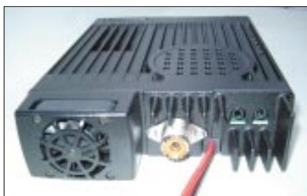
**Der asymmetrisch angeordnete Lüfter auf der Rückseite bläst die Kühlluft direkt durch die Endstufe. Außer dem Stromanschlußkabel gibt es lediglich zwei Klinkenbuchsen für Lautsprecher und eine PL-Buchse zum Antennenanschluß.** Fotos: U. Flechtner
