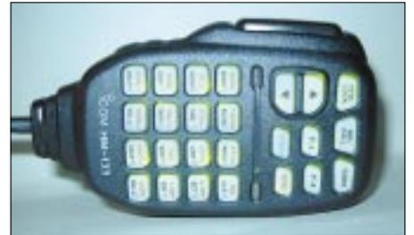
Die Funktionen lassen sich auch über das Mikrofon bedienen, dessen Tasten ebenfalls beleuchtet sind. Von unschätzbarem Vorteil ist, daß die Beschriftung auf den beleuchteten Tasten steht.
